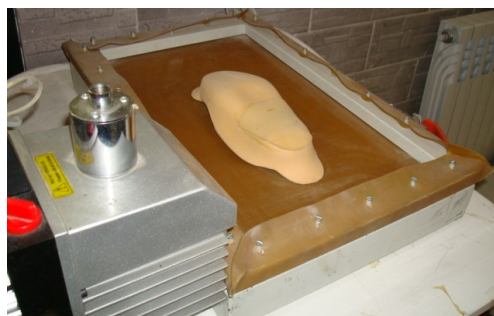
شکل ۱: شکل دادن پلی فوم روی قالب
