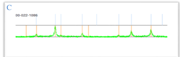
شکل ۲: (A) طرح پراش XRD نانوذرات فریت کبالت (CoFe 2 O 4 ), (B) فریت کبالت پوشش داده شده با سماق، (C) الگوی استاندارد XRD فریت کبالت.
