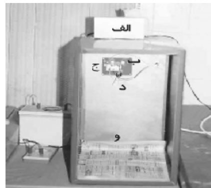
شکل ۲: دستگاه ویژه مولد امواج شبیه‌سازی شده تلفن همراه (MHz: ۹۱۵). الف) منبع تغذیه؛ ب) مولد فرکانس (VCD)، ج) تقویت‌کننده، د) آنتن و ه) اتافک
