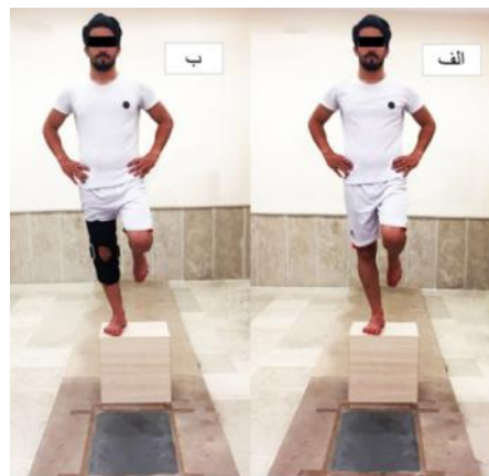
شکل ۲: فرود از روی سکوی ۴۰ سانتی‌متری بدون بریس زانو (الف) و فرود با بریس زانو با زاویه محدودیت فلکشنی ۳۰ درجه و ۶۰ درجه (ب)
