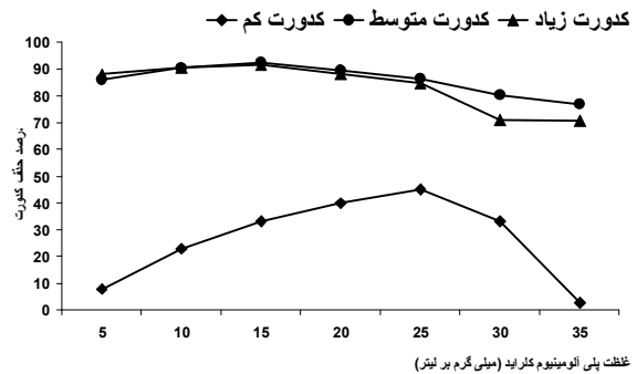
نمودار ۴: تعیین غلظت بهینه پلی آلومینیوم کلراید در کدورت‌های کم (کمتر از 30 \text{ NTU} )، کدورت متوسط ( 100-130 \text{ NTU} ) و کدورت‌های بالا ( 200-230 \text{ NTU} ) ( \text{pH}=7 )
